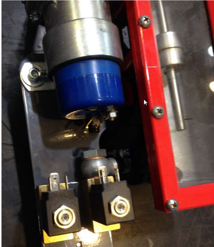
Pumpe, Ablaufventil links, Zulaufventil rechts, Schauglas mit Schwimmer
